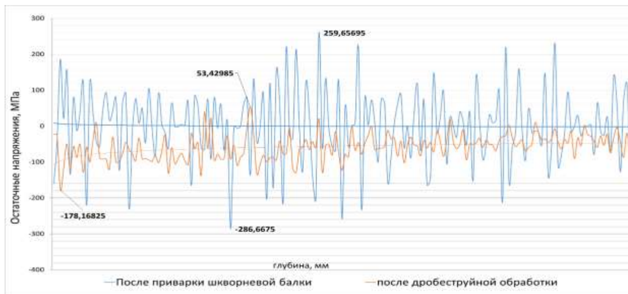
Рисунок 3.45 – Среднеквадратическое отклонение результатов исследования распределения остаточных напряжений до и после дробеструйной обработки изделия
