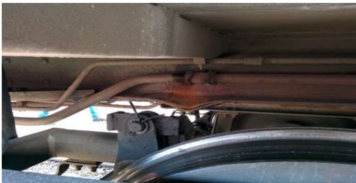
Рисунок 3.12 – Деформация хребтовой балки вагона модели 61-850
