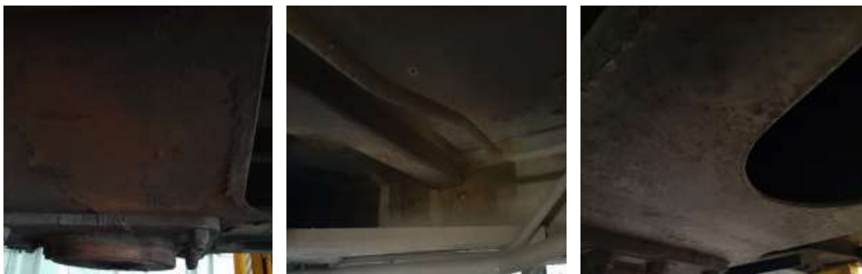
Рисунок 3.8 – Коррозионное воздействие на элементы хребтовой балки вагона модели 61-4191
