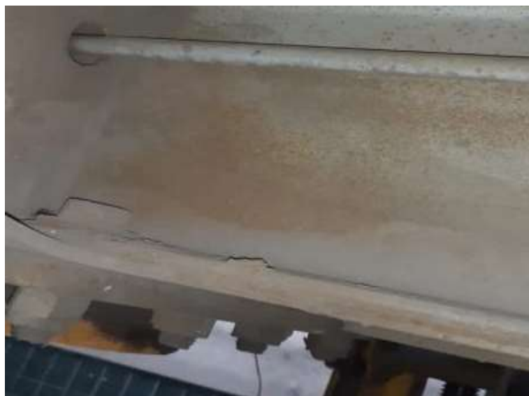
Рисунок 3.6 – Пример коррозионных пятен на хребтовой балке вагона модели 61-821
