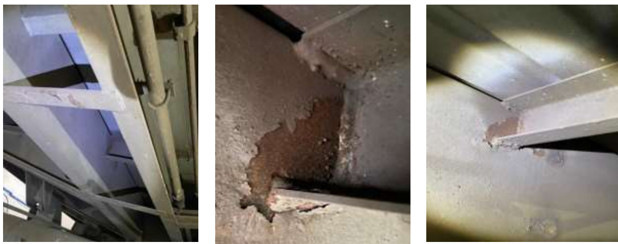
Рисунок 3.8 – Коррозионное воздействие на элементы хребтовой балки вагона модели 61-4191
