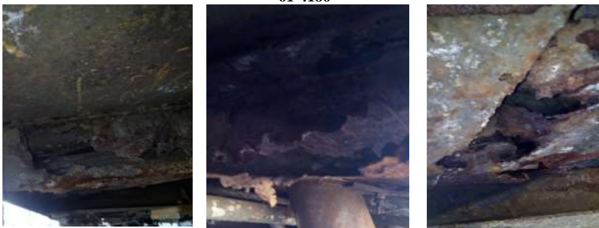
Рисунок 3.10 – Состояние экипажной части вагона модели 61-836
