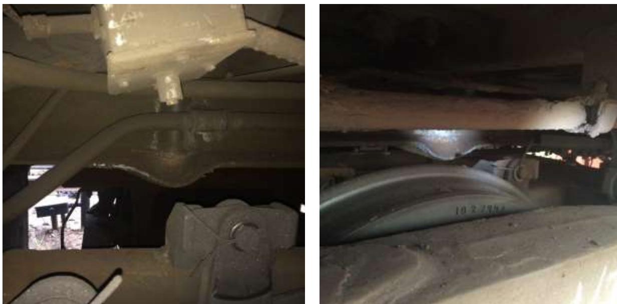
Рисунок 3.13 – Деформация хребтовой балки вагона модели 61-4179
